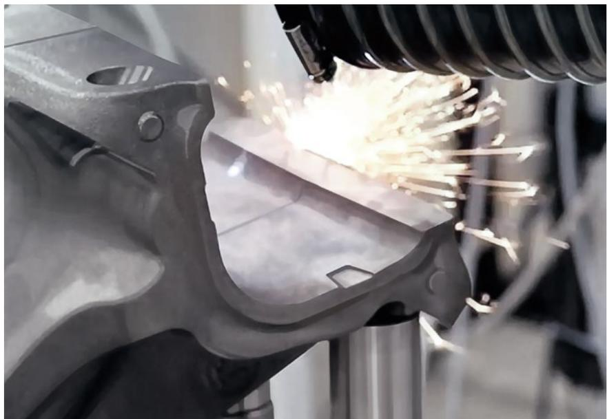
**BILD 3** Durch ein innovatives Laserverfahren werden die Geometrie der Anlageflächen und die metallurgischen Eigenschaften der Schnittstelle zwischen Achskörper, Gusslenker und Balgträger optimiert (© BPW)
